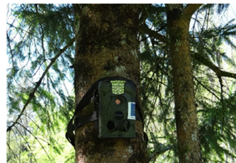
Kamera, nameščena na območju postavitve dinamičnega prometnega znaka za videonadzor živali v bližini senzorjev.
