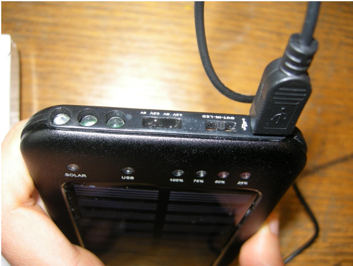
Slika 4: Nastavljivi gumb, indikatorji in LED lučke.
