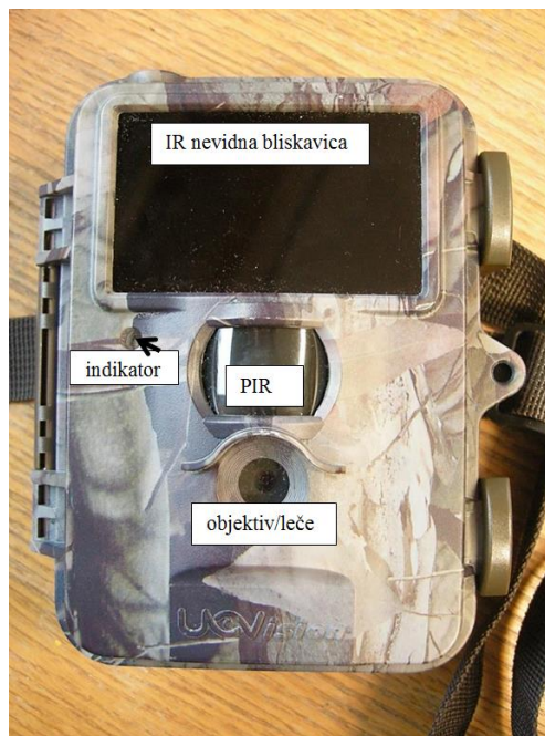
Slika 2: Avtomatska kamera namenjena spremljanju prisotnosti medveda in drugih vrst prostoživečih živali na krmišču. Označeni so tudi glavni sestavni deli kamere.
