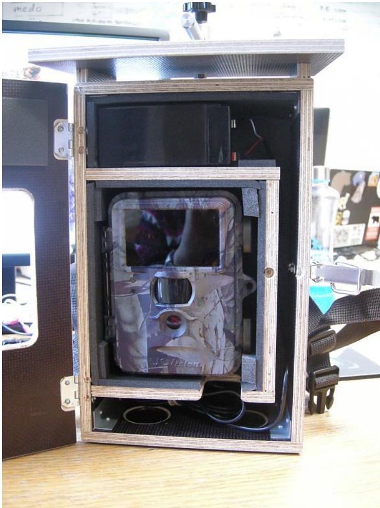
Slika 1: Razporeditev opreme v notranjosti lesenega ohišja.
