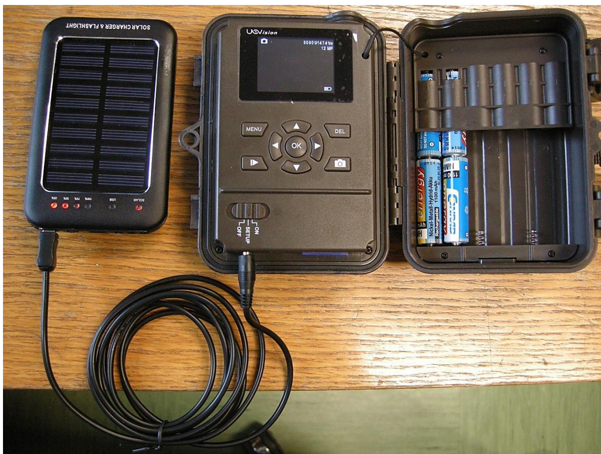
Slika 6: Priklop baterije s sončnimi celicami na kamero s priloženim kablom.
