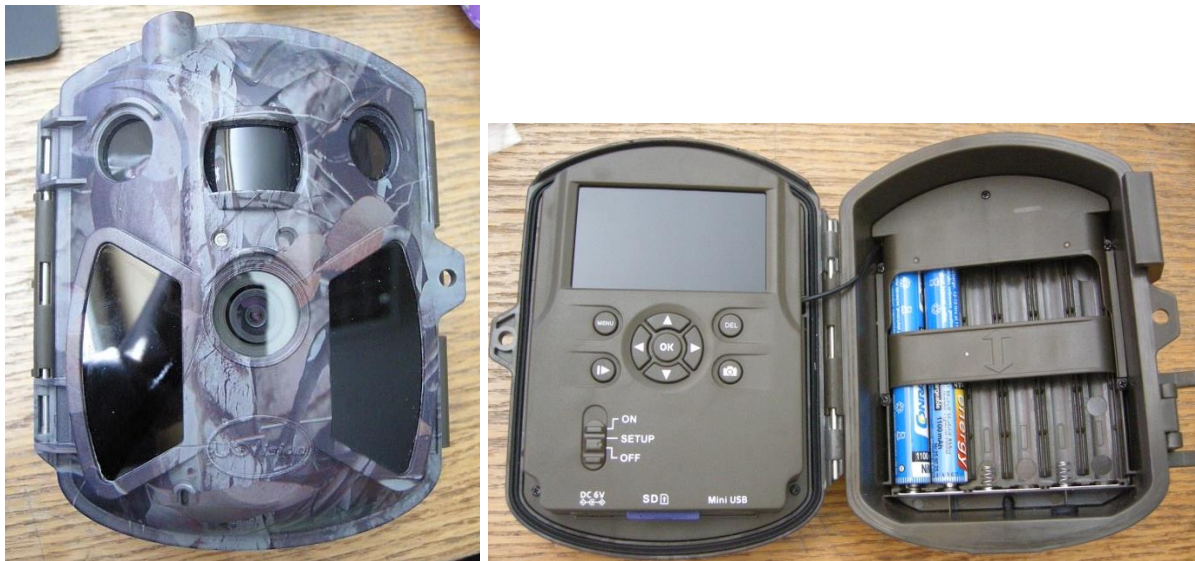
Slika 6: Sprednja stran in notranjost modela kamere UV 575 (PIR = pasivni infrardeči senzor).
