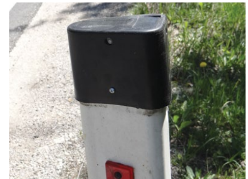
Akustische Abschreckanlagen wurden an den gefährlichsten Streckenabschnitten an den Straßenpfosten montiert.
