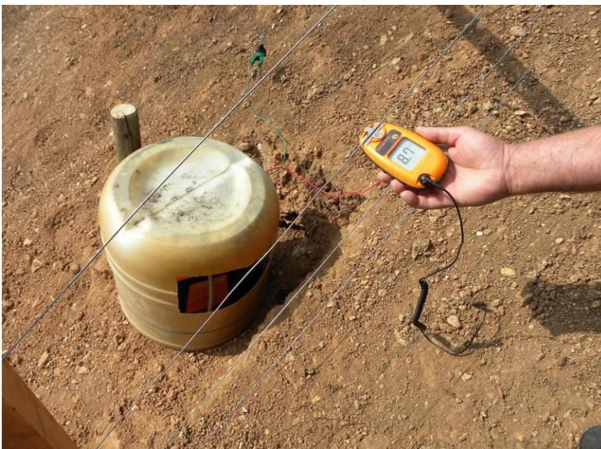
Figura 3.7 - Misura della tensione in un filo conduttore (Foto Asson Daniele).
