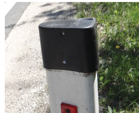
Zvučne plašilice sa sensorima postavljene su na prometnim stupićima uz cestu na najkritičnijim dijelovima ceste.
