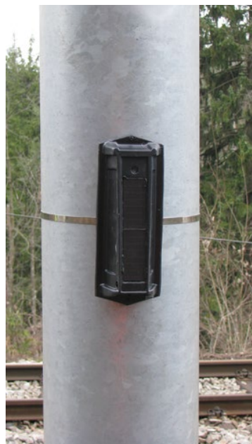
Zvučne plašilice postavljene su na električnim stupovima duž pruga u Sloveniji kako bi se smanjili sudari vlakova i medvjeda.
