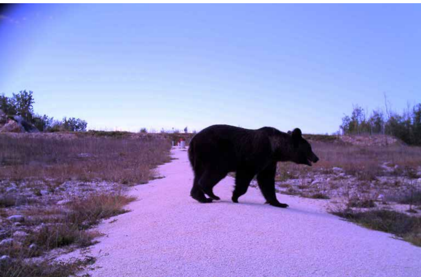
Pijesak u kombinaciji sa sensorima i fotozamkama može učinkovito mjeriti aktivnost divljih životinja tijekom prelaska preko autocesta te je moguće diferencirati vrste, a ponekad i individualne životinje (Gužvica, G.).
