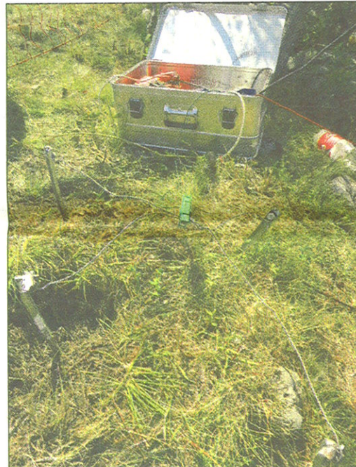
Ustrezna ozemljitev in pokošena trava na trasi elektromreže sta predpogoja za prisotnost ustrezno močnih pulzov v elektromreži (Foto: Matej Vidrih, Oddelek za agronomijo, Biotehniška fakulteta).
