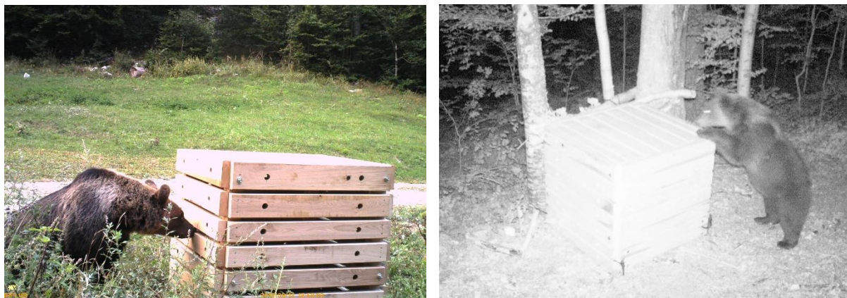
Slika 9: Testiranje medovarnega kompostnika na krmišču za medvede. V dobro sidranem kompostniku je bila hrana za medvede nedostopna.
